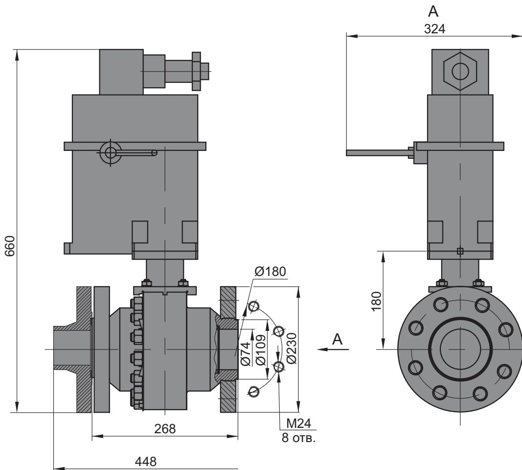
**Обозначение изделия****КШ-80-100-ЭП-НУ-УХЛ1-Ф-Ф****Обозначение чертежа****1.2750.236.306.00-01**
