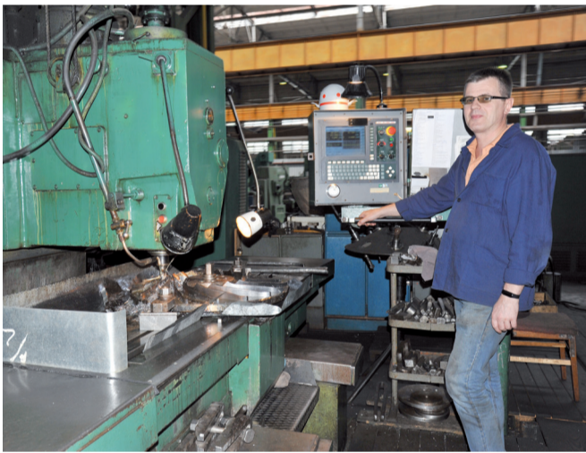
Процес виготовлення колеса для ротора пропанових компресорів Олексієм Дягілем у цеху № 12
