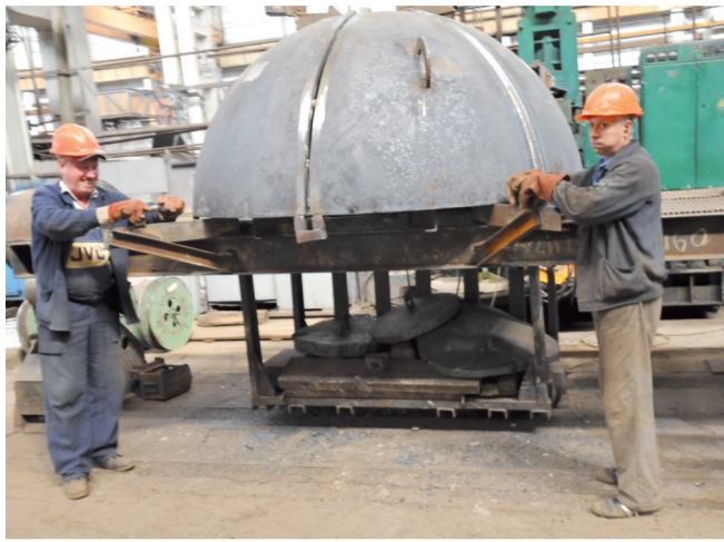
Шлакоче зварювання днища фільтра сепаратора бригадою Олександра Пономарьова в цеху № 4
