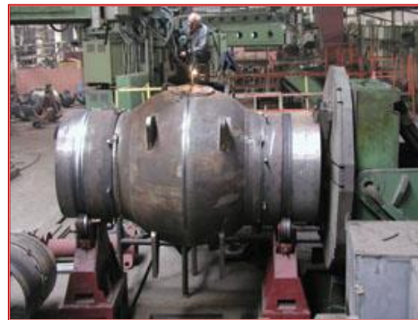
Сварка замыкающего стыка крана шарового Ду100
