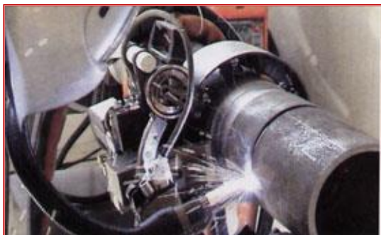
Установка для автоматической сварки труб фирмы «FRONIUS», Австрия
