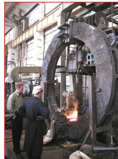
Электрошлаковая сварка крупногабаритных фланцев
