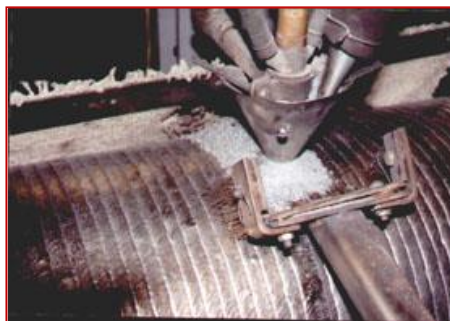
Автоматическая наплавка порошковой проволокой плунжера
