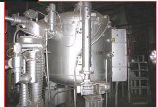
Вакуумная печь для пайки твердосплавных пластин ТН-20 к секторам из нержавеющей и углеродистой стали
