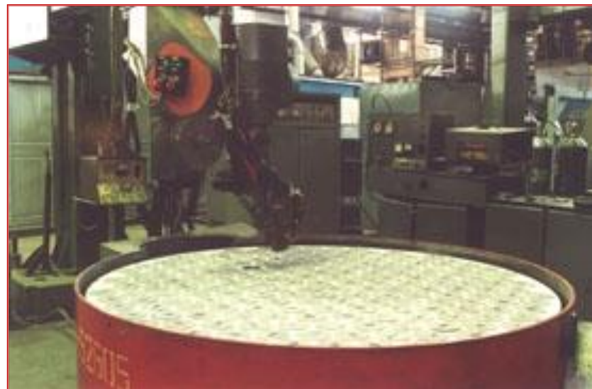
Электрометаллизация алюминием стальных деталей дистанционных решеток
