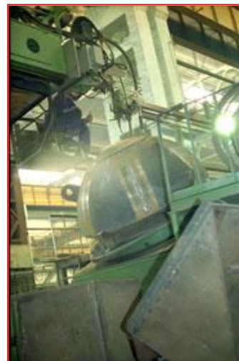
Автоматическая сварка сферических днищ на установке для автоматической сварки фирмы «Дойма», Германия
