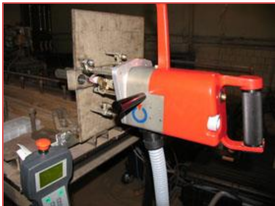
Сварка образцов труба-трубная решетка на установке для автоматической сварки фирмы «FRONIUS», Австрия
