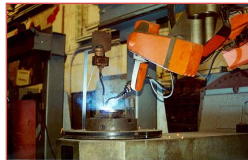
Наплавка колец разгрузки релитом на роботах фирмы «ИГМ», Австрия
