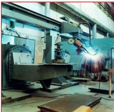
Робототехнический комплекс для сварки и наплавки рабочих колес центробежных насосов
