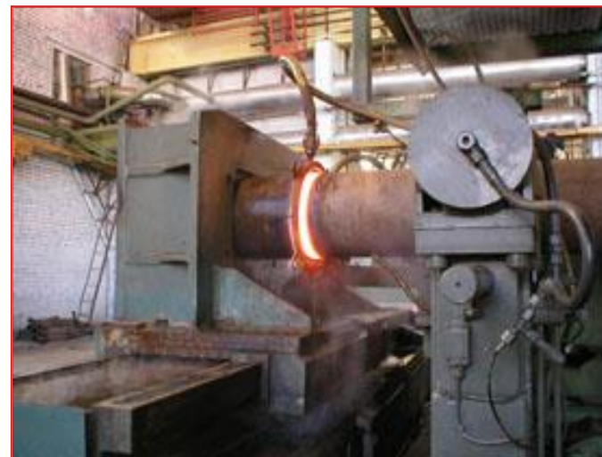
Гибка труб на установке с нагревом токами высокой частоты
