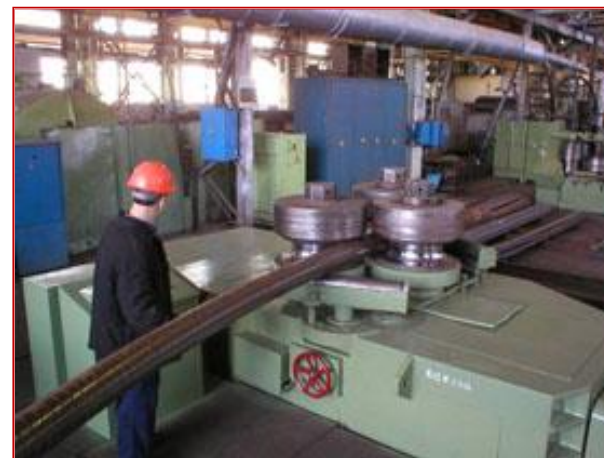
Гибка труб нахолодно на вертикальной сортогибочной установке THL-4
