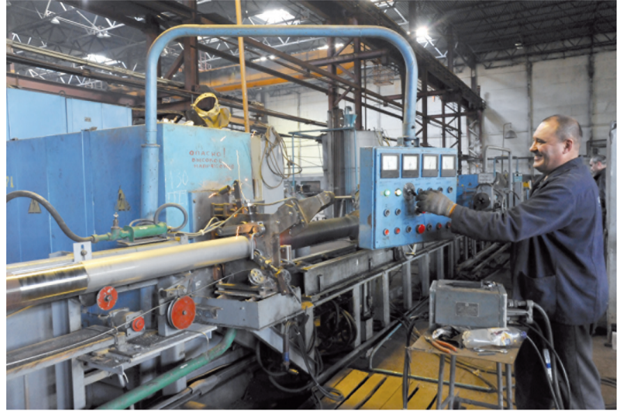
Оператор установки Ігор Калініченко, який безпосередньо виконує оребрення на трубі
