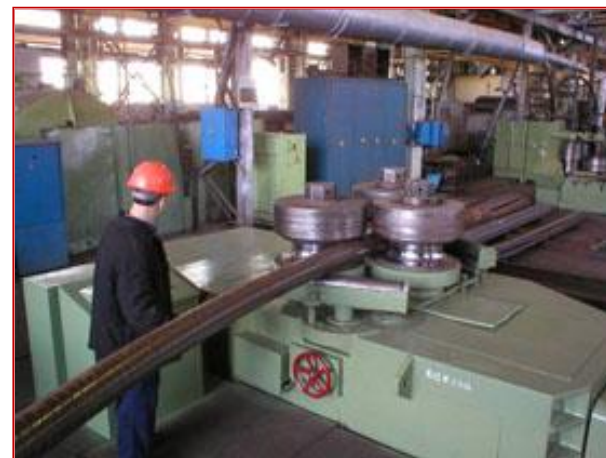
Згинання труб нахолодно на вертикальній сортозгинальній установці THL-4
