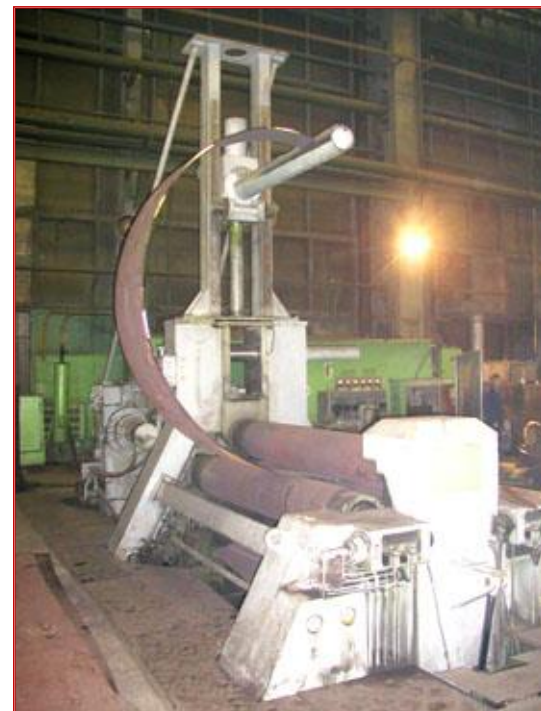
Вальцювання обичайок на горизонтальних листозгинальних вальцях фірми «Хойслер»
