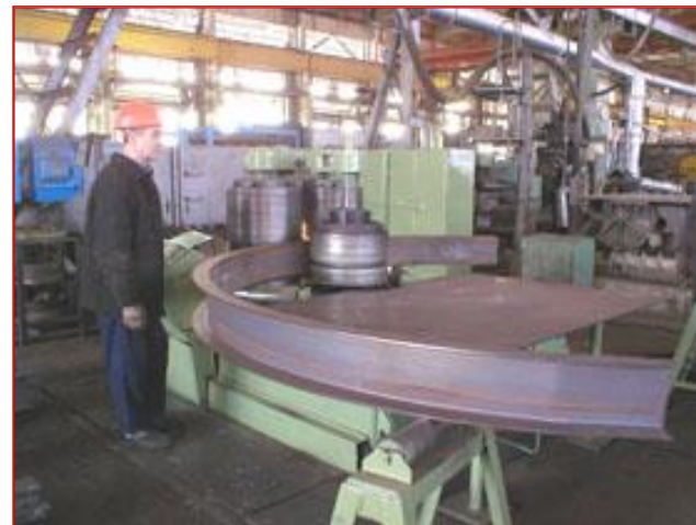
Холодне згинання кілець жорсткості на вертикальній сортозгинальній установці THL-4
