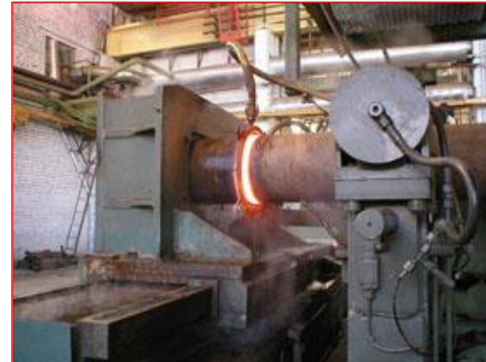
Згинання труб на установці з нагрівом струмами високої частоти
