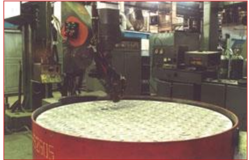
Електрометалізація алюмінієм сталевих деталей дистанційних решіток
