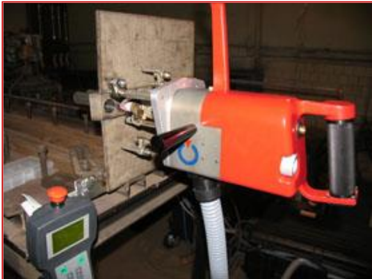
Зварювання зразків труба-трубна решітка на установці для автоматичного зварювання фірми «FRONIUS», Австрія
