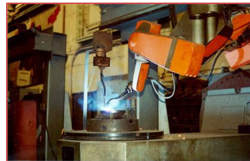
Наплавка кільця розгрузки релітом на роботах фірми «ІГМ», Австрія
