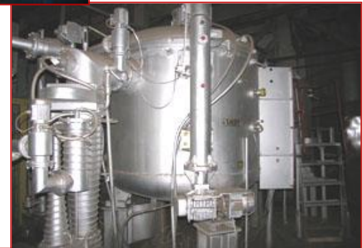
Вакуумна піч для пайки твёрдосплавних пластин ТН-20 до секторів з нержавіючої і вуглеродистої сталі
