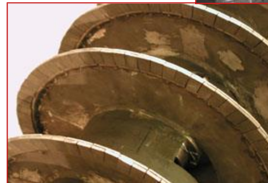
Шнек центрифуги с твёрдосплавными пластинами ТН - 20. Пайка пластин проводится в вакуумной печи припоем ВПР - 2
