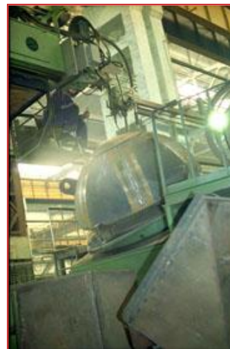
Автоматичне зварювання сферичних днищ на установці для автоматичного зварювання фірми «Дойма», Німеччина
