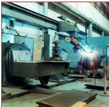
Робототехнічний комплекс для зварювання і наплавки робочих колес відцентрових насосів
