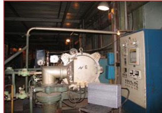
Вакуумна піч для пайки твёрдосплавних пластин ТН-20 до секторів з нержавіючої і вуглеродистої сталі
