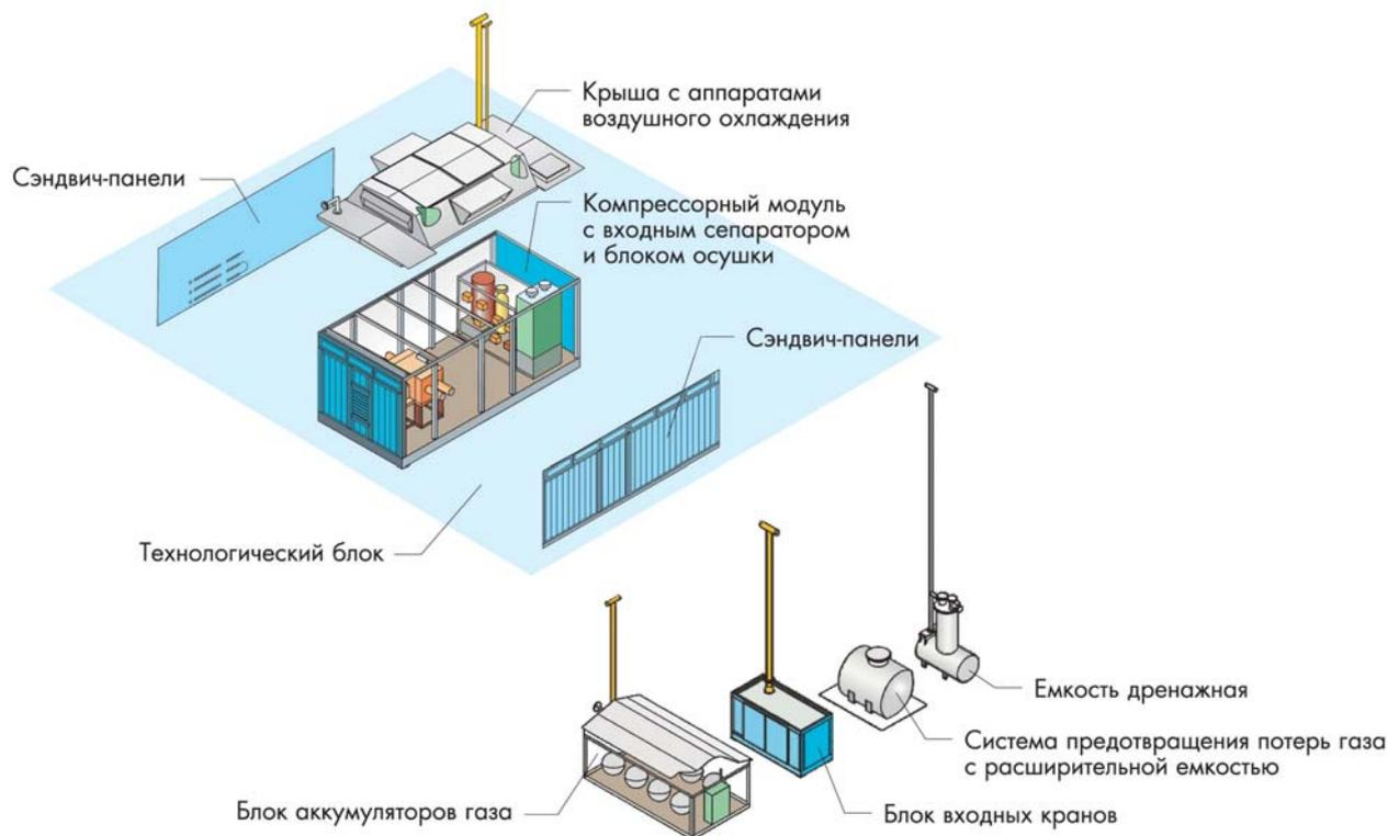
Для расширения функциональных возможностей однокомпрессорных станций предлагается следующий комплект оборудования:
