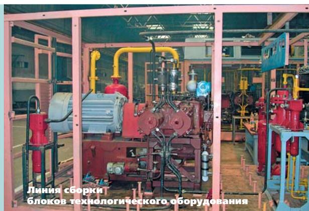
Технологическое оборудование АГНКС поставляется отдельными модулями и блоками полной заводской готовности.
