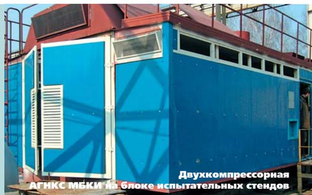
Двухкомпрессорная АГНКС МБКИ на блоке испытательных стендов
