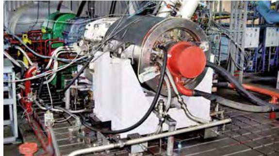
**Стенд натурных испытаний центробежных компрессоров** позволяет испытывать их при рабочих значениях параметров природного газа с измерением не только производительности, мощности, КПД и т.п., но и осевой силы на ротор, уровня вибрации, утечек через «сухие» уплотнения.
