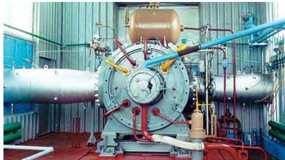
**Стенды для натурных испытаний ГПА.** На каждом из трёх имеющихся замкнутых газовых контуров проходят испытания опытные образцы газоперекачивающих агрегатов с мощностью привода до 25 МВт.
