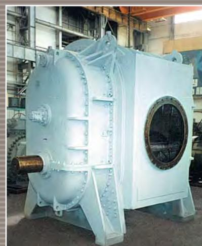
К одному из основных видов оборудования, выпускаемого АО «СМНПО-Инжиниринг», относятся центрифуги, изготовление которых начато на предприятии ещё в 1902 году.
