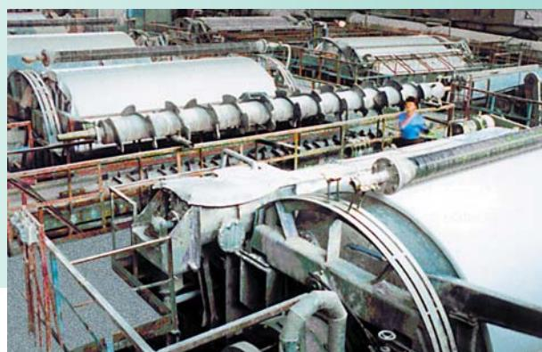
Предназначены для фильтрования труднофильтруемых суспензий при производстве двуокиси титана (ББМ45-3,14-1Г), бикарбоната натрия при производстве кальцинированной соды (ББ-5,4 и БЯН-180), а также в ряде других технологических процессов химической промышленности.
