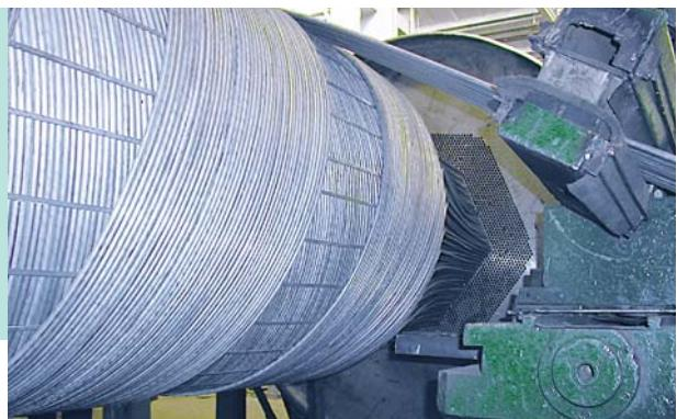
На предприятии разработано, изготовлено и внедрено оборудование для механизированного изготовления резервуаров емкостью 5 000 м<sup>3</sup>, 10 000 м<sup>3</sup> и 20 000 м<sup>3</sup> методом рулонирования.
