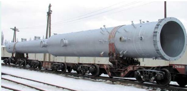
Применяется для ректификационных и абсорбционных процессов в химической и других отраслях промышленности. Разрабатывается оборудование по индивидуальным проектам и может быть изготовлено из углеродистых и коррозионностойких сталей, титановых сплавов и сплавов на основе никеля (хастеллой-С).
