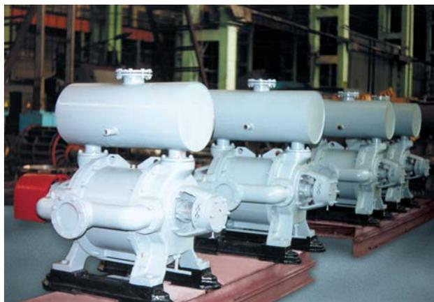
Предназначены, в зависимости от материала проточной части, для отсасывания воздуха (создания вакуума), инертных или агрессивных газов, нерастворимых в воде, с целью создания или поддержания вакуума. Рабочей жидкостью служит вода.
