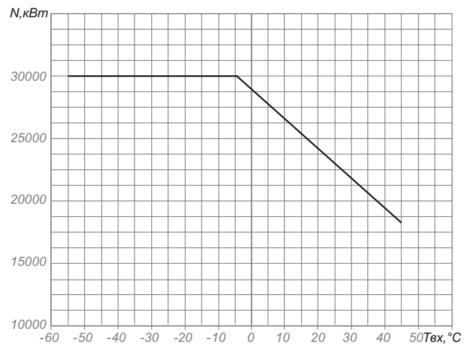
Обмеження потужності ДУ80Л1 в залежності від температури повітря на вході в двигун
